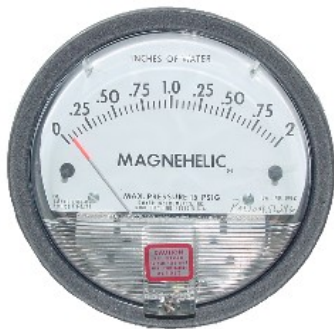
รูปที่ 7.2 มาตรวัดความดันสถิต ซึ่งติดตั้งเหนือหน้าต่างของตู้ควัน
